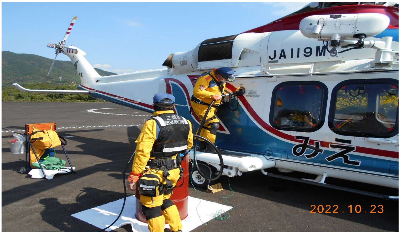
■ 三重県航空防災ヘリコプターへの燃料供給状況
